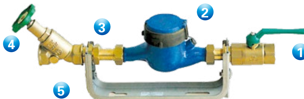
Eine komplette Wasserzähleranlage besteht (von rechts in Fließrichtung) aus fünf Bestandteilen. Absperrarmatur 1 und Wasserzähler 2. Das längenveränderliche Ein- und Ausbaustück 3 dient dem spannungsfreien Ein- und Ausbau des Wasserzählers. Es folgt die ausgangseitige Absperrarmatur 4. Alles sitzt im Wasserzählerbügel 5. Dieser Potenzialausgleich sorgt für die elektrische Überbrückung (sonst Lebensgefahr!) und gibt der gesamten Anlage Stabilität.
